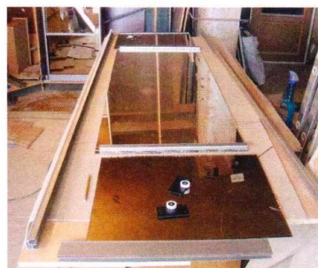
Сборка зеркальной дверки с тонированными частями.
